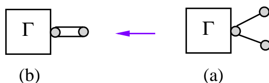
شکل ۵: با حذف کردن اتصالات یک خطی در دیاگرام سمت چپ به دیاگرام سمت راست می‌رسیم که یک دیاگرام غیرمجاز است.
