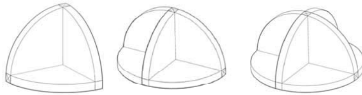
شکل ۵- گره های سبک تر جهت گوشه ها و لبه ها
