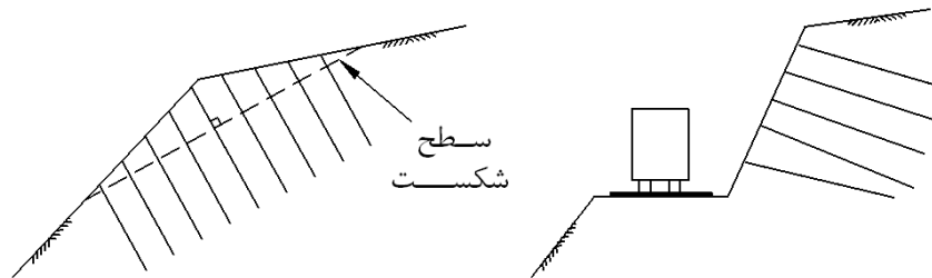
شکل (5-9): مسلح کردن شیب های خاکی و سنگی با میل مهارهای فلزی
