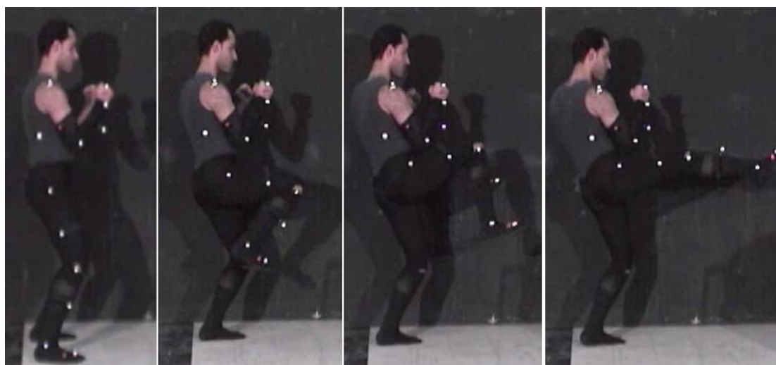
شکل ۴: محل نصب مارکرها و مراحل اجرای حرکت مایی‌گری طی آزمون
