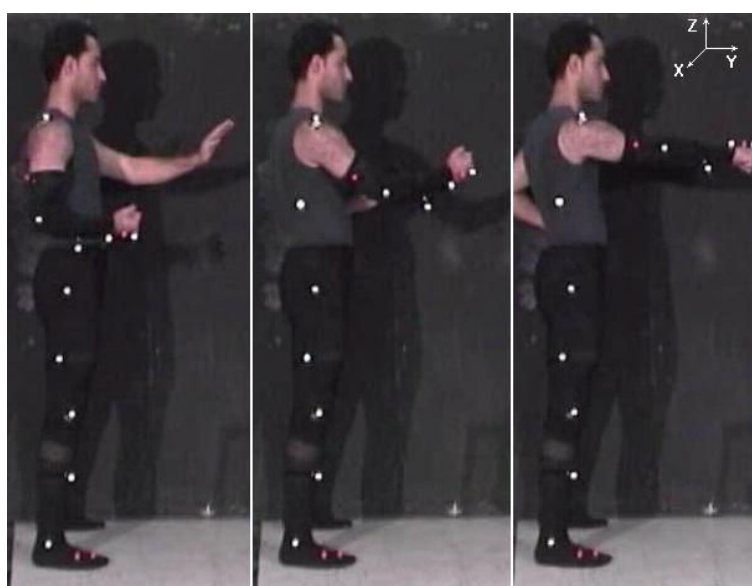
شکل ۲: محل نصب مارکرها و مراحل اجرای حرکت زوکی طی آزمون
