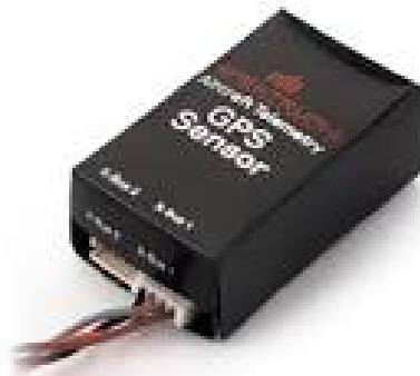
(ج) حسگر جی‌پی‌اس، قابل استفاده برای مکان‌یابی کل نقاط کره زمین با دقت ۰/۰۱ متر [۷۶].
